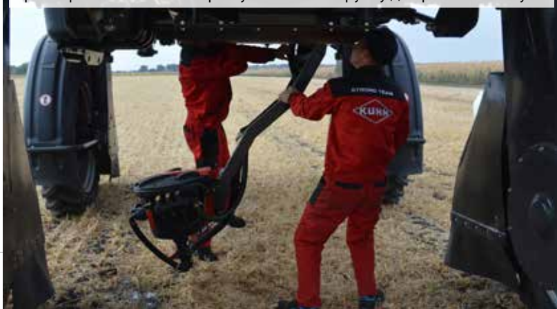
При кліренсі 170 см міксер опускається на зручну для роботи висоту
